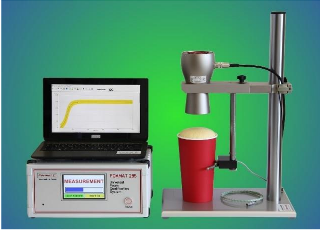
الشكل ١. قياس منحني نمو الرغوة باستخدام جهاز Foam Meter
