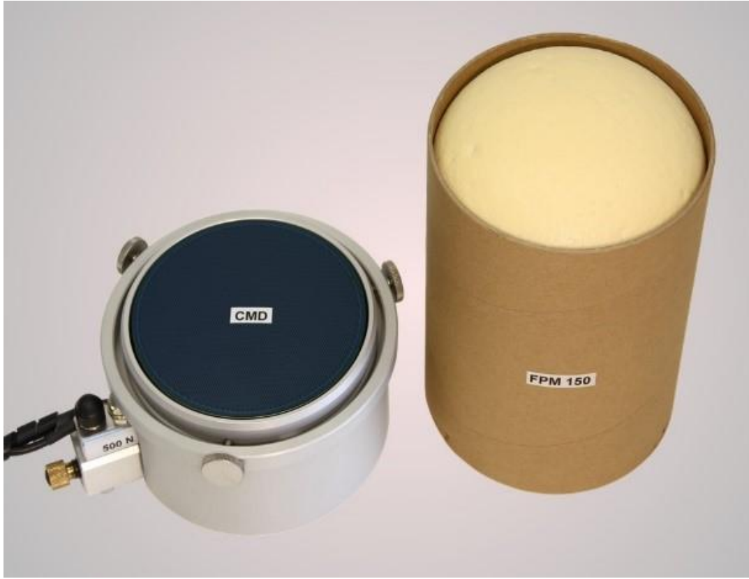
الشكل ٢. قياس ضغط الارتفاع أثناء تكوّن رغوة البولي يوريثان
