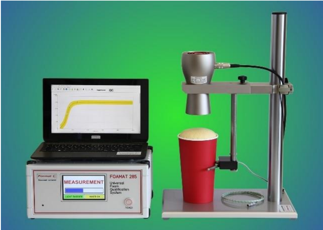
图 1. 使用 Foam Meter 测量聚氨酯泡沫上升曲线
