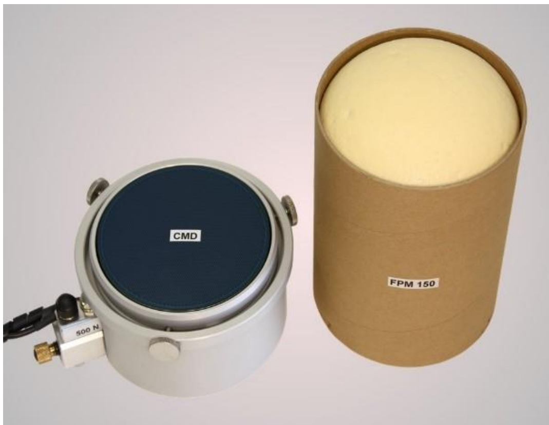
图 2. 聚氨酯泡沫形成过程中的上升压力测量
