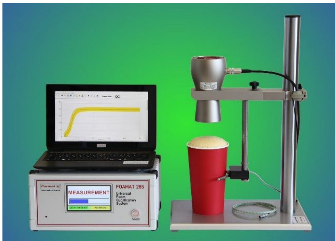
Рис. 1. Измерение профиля роста пенополиуретана с помощью Foam Meter
