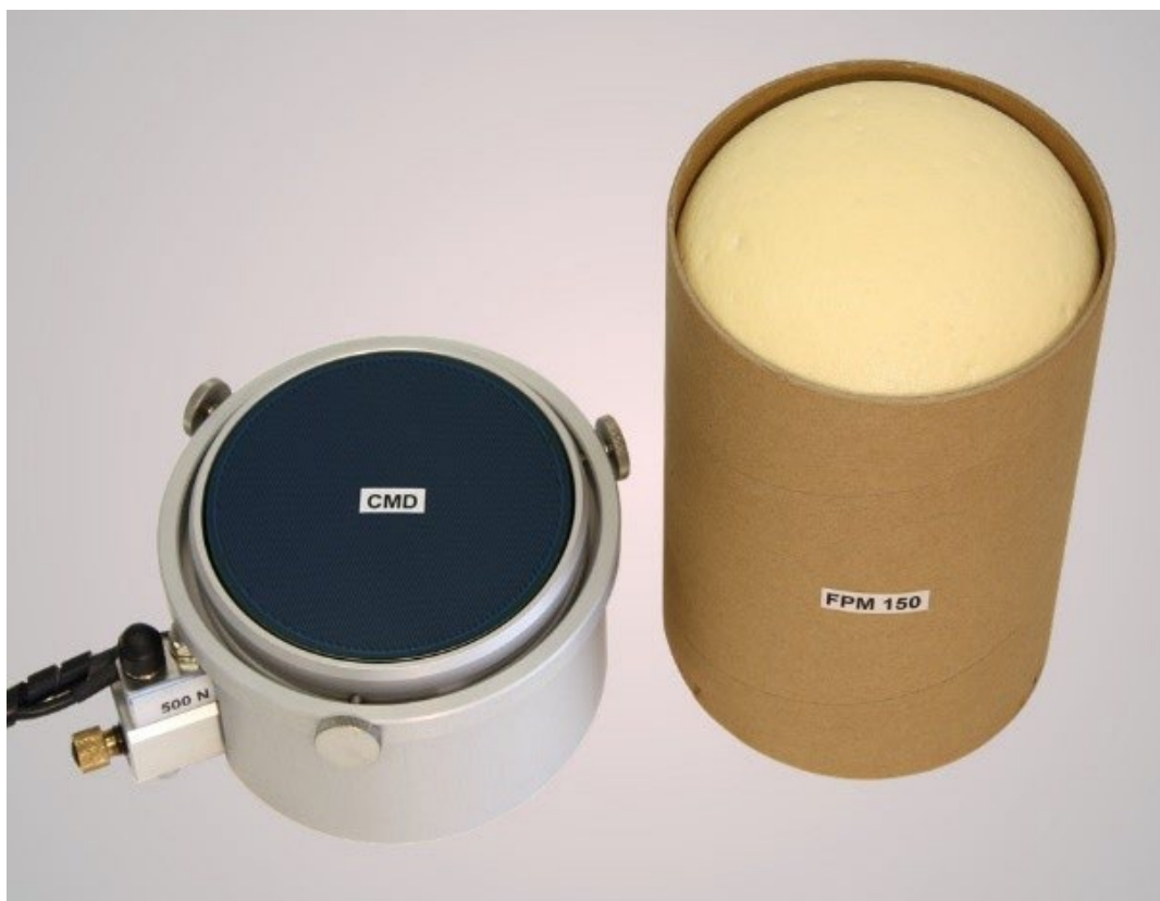
Рис. 2. Измерение давления при подъеме пенополиуретана в процессе образования пены
