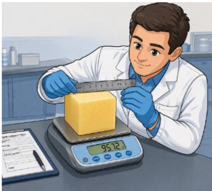
Рисунок 2 — Измерение плотности пены
