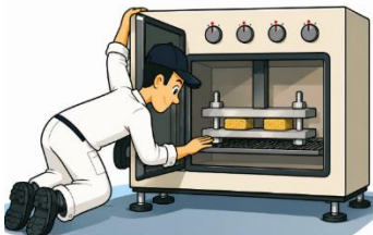
شکل ۶ - آزمون مانایی فشاری
