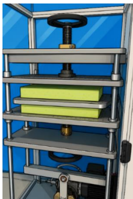
شکل ۱۰- آزمون مانایی فشاری برای سنجش خستگی استاتیکی
